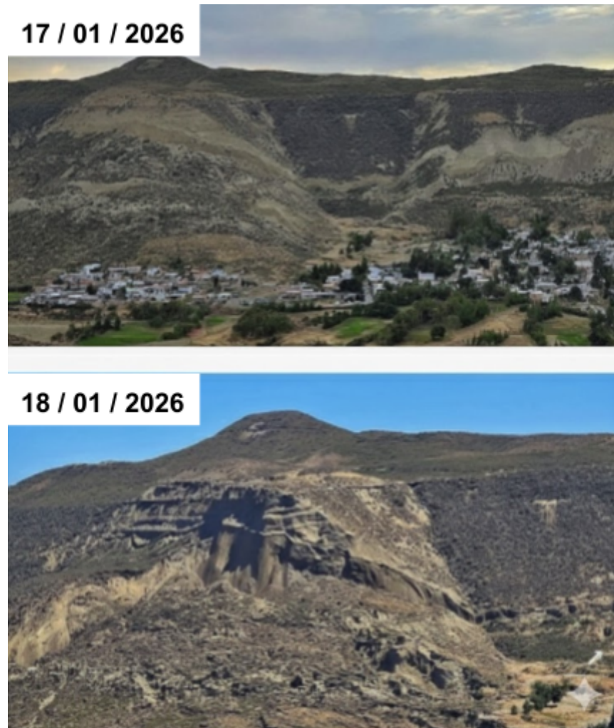
Figura 6. Evolución temporal de la reactivación del deslizamiento en el Cerro Hermitte, Comodoro Rivadavia (17-18 de enero de 2026). Nótese la formación del nuevo escarpe principal, y el desplazamiento de los bloques sedimentarios de la Formación Chenque.
